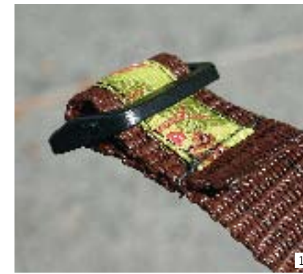
1 Den Dreisteg an einem Ende des Bandes einfädeln und festnähen.
